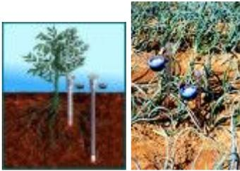
Tensiômetros instalados no campo
