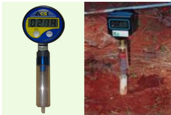
Tensiômetro com tensímetro (medidor de vácuo digital)
