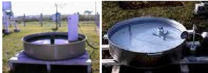
Tanque Classe “A” na estação meteorológica
